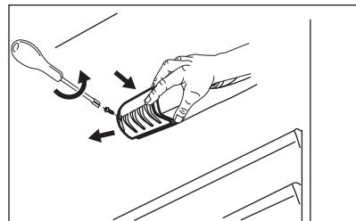
3. Cambie la bombilla por otra de las mismas características y diseñada específicamente para electrodomésticos.
